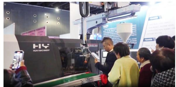
应用前景受到专业人士高度关注。浙江舟山华亿机械制造有限公司展出的免烘烤排气式注塑机(见图),突破了传统注塑工艺中原料必须预烘干的技术瓶颈,实现了工程类原料的直接投料生产,填补了国内高端塑料加工装备领域技术
