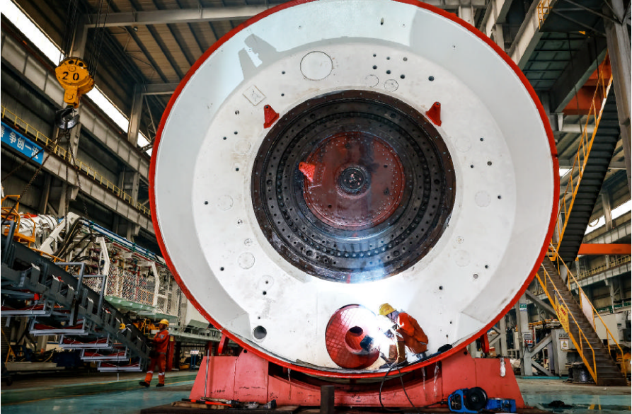
10月27日,中铁科工集团轨道交通装备有限公司技术工人对盾构机盾体进行电焊作业 新华社 发(赵军 摄)
