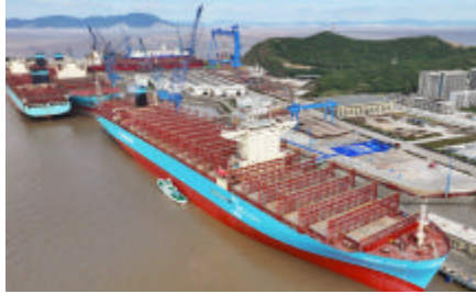
2024年10月29日,普陀西白莲岛,全球首艘马士基14000TEU“MAERSK HALIFAX”轮甲醇双燃料改装完工并交付 图/杨义鸿
