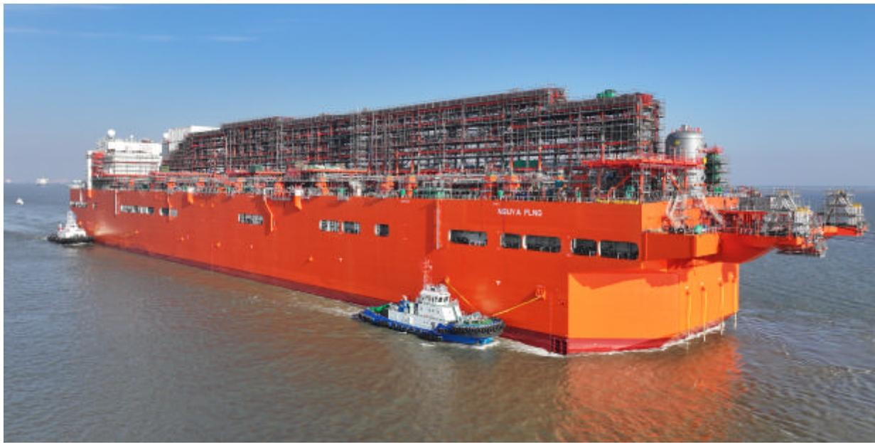
昨天,大型浮式天然气液化装置“NGUYA FLNG”轮在拖轮拖带下行驶在长江江苏太仓段(无人机照片)。当日,我国首座大型浮式天然气液化装置“NGUYA FLNG”轮从江苏南通开发区顺利拖航出江,前往浙江舟山进行上部模块安装、集成和调试。据了解,浮式天然气液化装置(FLNG)能够在深远海直接将开采出的天然气液化并储存,是海洋工程装备中建造复杂、附加值大的一类产品。
