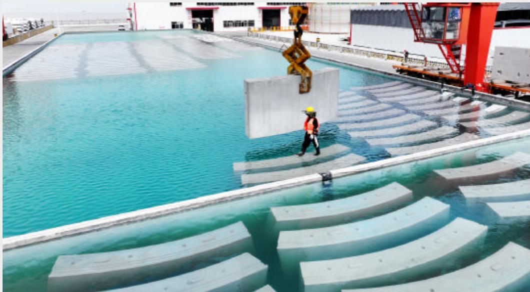
昨天上午,中铁十一局甬舟铁路金塘海底隧道管片制作场,工人们正有条不紊地忙碌着。为保障金塘高铁海底隧道盾构管片所需,工人们夜以继日,以日产管片7环、箱涵8节的速度为盾构掘进前方提供“粮草”。据了解,该局共需生产管片3130环、箱涵3153节,目前已完成644.6环、403节。摄影 通讯员 姚峰 周俊 侯丹珠
