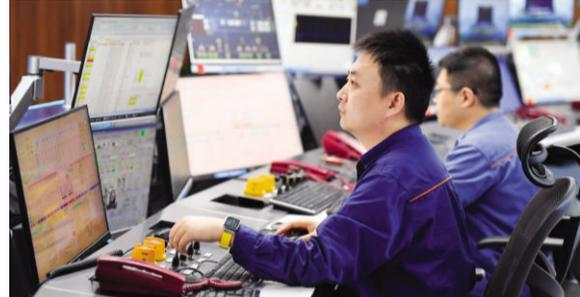
2024年6月13日,在位于湖南省湘潭市的湘潭钢铁集团有限公司五米宽厚板厂智慧中心,工作人员在远程操作精炼设备。五米宽厚板厂智慧中心利用超融合、虚拟化、5G传输以及分布式计算和存储等技术,将五米宽厚板、轧钢和热处理全工序的控制和二级、三级系统进行整合,改善工人的工作环境,提高生产的自动化程度和效率。
