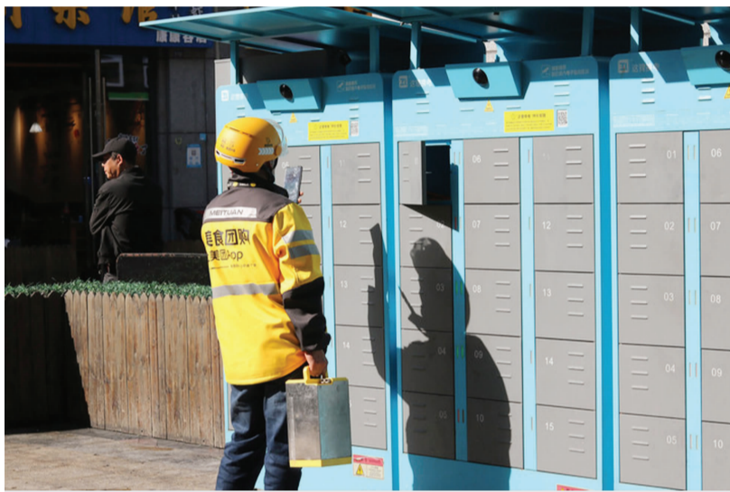
杭州街头，一位外卖员手提电动自行车电池，正准备在“这锂换电”换电柜更换电池
