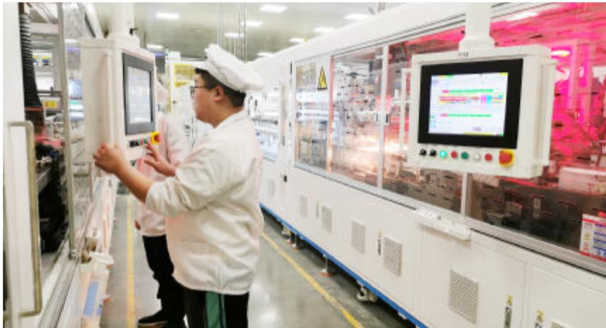
测试等多道工序,仅16秒左右,电池片、钢化玻璃、胶膜、边框等材料就被组装成1块光伏发电板。
