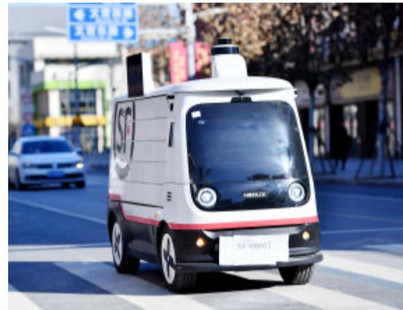
1月22日,无人驾驶配送车在派送邮件。近日,无人驾驶配送车在雄安新区投入使用。收件人可以在手机APP上预约派送时间,无人驾驶配送车到达前会自动发出短信通知收件人,到达指定地点后,收件人输入取件码即可取件。据介绍,该无人驾驶配送车最大承重为1000千克,单车日配送量达到500-800单,满电续航200公里,可以实现1分钟换电。
