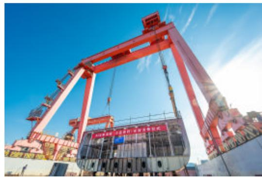
昨天上午,在浙江凯灵船厂,一艘“小島你好”新型游轮式客滚船完成龙骨安放,随后将进入船体合拢阶段。该船总长84.53米、型宽16.00米,设计载客451人,可承运客车、货车等各式车辆。船舶一至三层设有水吧、咖啡吧、观光休闲餐吧区、儿童游乐区、商务休闲区等。预计明年上半年建成,投入岱山燕窝山—嵊泗沈家湾航线。
