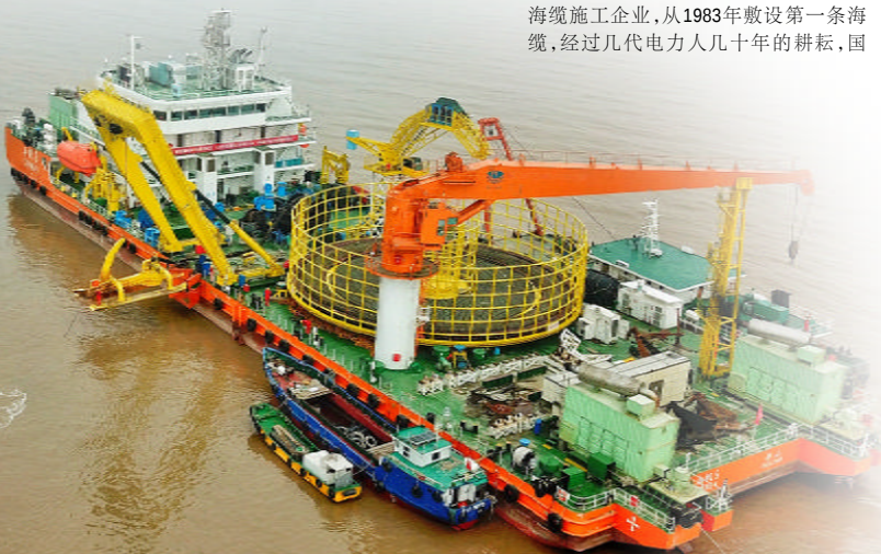
“启帆9号”海缆施工船
